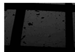
24NM034031-001 - Grille 1 Filtres 01-02-03-04 Grandissement x1000 Obscurcissement estimé \leq 10\%
